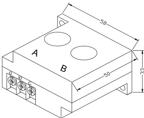
图 4.1.1、CT2 结构尺寸（ $\phi 10$  穿孔）
